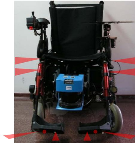
**Figura 4.** Porción del espacio escaneado por el anillo de sensores infrarrojos. Los sensores están situados en posiciones que complementan el espacio muestreado por el escáner laser radial.
