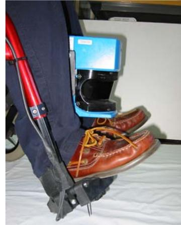
**Figura 3.** El escáner láser radial proporciona información valiosa del entorno que permite a SENA evitar obstáculos, localizarse, crear mapas, etc. Su emplazamiento delante de la silla le permite escanear la parte frontal sin molestar al usuario.
