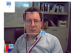
Figura 3: Salida del seguidor de caras realizado con un filtro de Kalman .
