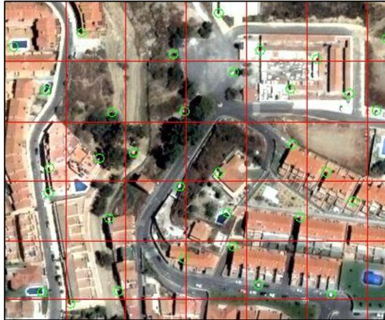
Figura A-3. Puntos de control distribuidos homogéneamente.
